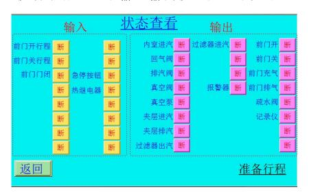
显示输入输出通断状态, 按动返回键, 则返回目前行程。
